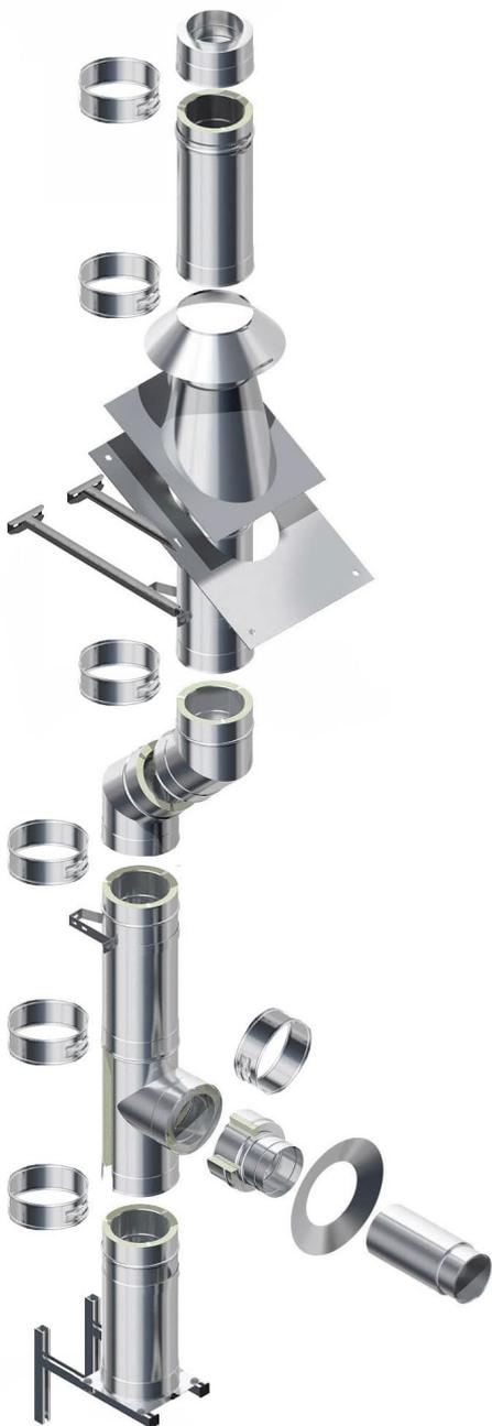
Die Abgasanlage darf schräggeführt werden. Zulässig sind Schrägführungen bis max. 90° (empfehlenswert max. 45°). Oberhalb der Schrägführung ist eine Zwischenstütze erforderlich, wenn die Höhe der Abgasanlage mehr als ca. 1m beträgt, andernfalls genügt ein Wandhalter. Zwischenstützen sind gegebenenfalls auch bei großen Bauhöhen und großen Nennweiten erforderlich. Hier ist das Informationsblatt „Maximal statische Montagehöhen und Abstände“ zu beachten.
